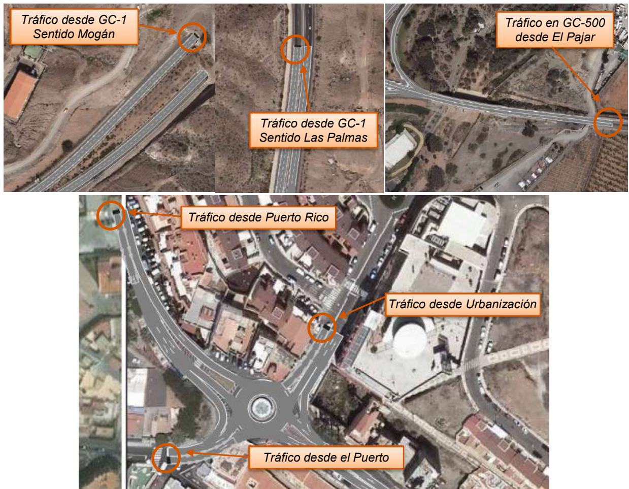
Ilustración 5.2.IV.- "Vehicle Inputs" establecidos en el modelo de tráfico de la Configuración Vial Actual
