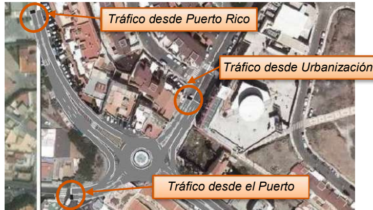
Ilustración 5.3.IV.- “Vehicle Inputs” establecidos en el modelo de tráfico de la Configuración Viaria Futura
